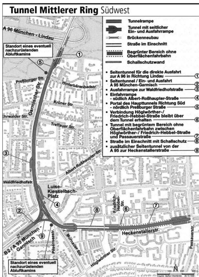
Der größte Straßenausbau am Mittleren Ring: Der 2,8 Kilometer lange Tunnel soll vor allem den Verkehr am Nadelöhr Luise-Kiesselbach-Platz reduzieren.
